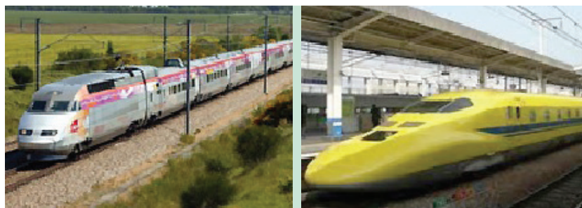
18. ábra. Példa a nagysebességű mérővonatokra (balra: Iris 320, Franciaország; jobbra: Dr Yellow, Japán) (DAMILL)
