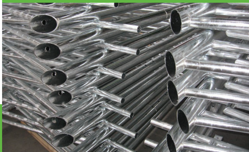
6. ábra. A robusztus fémbevonat metallurgiai kapcsolattal kötődik a vashoz
