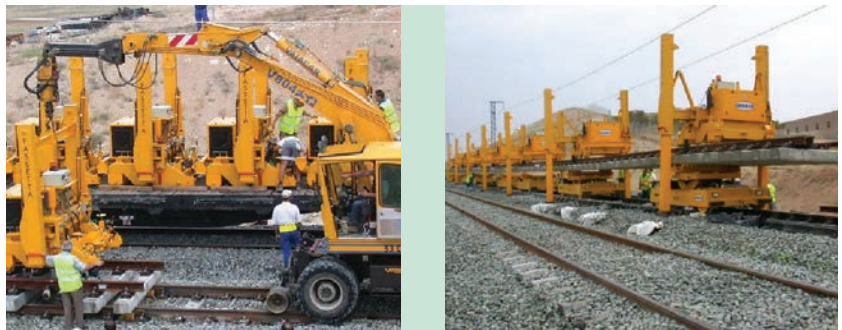
14. ábra. A Vaicar gerendás darurendszer rajza (Forrás: Vaicar)
