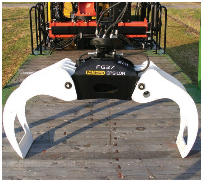
5. ábra. Adapter az aljak és rönkök rakodásához
