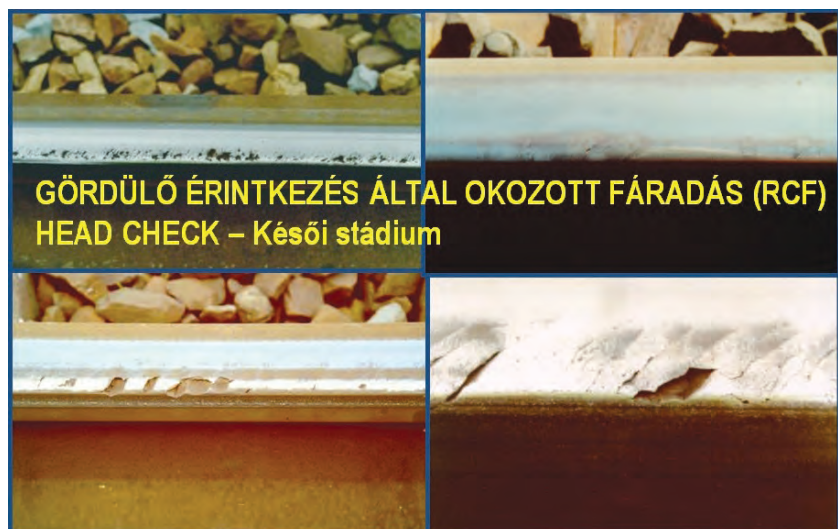
3. ábra. Head Check késői stádiumban
