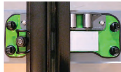
36. ábra. SEÖ kétgörgős szerkezet felülnézete
