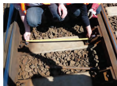
55. ábra. Az átlós furattávolság ellenőrző mérése
