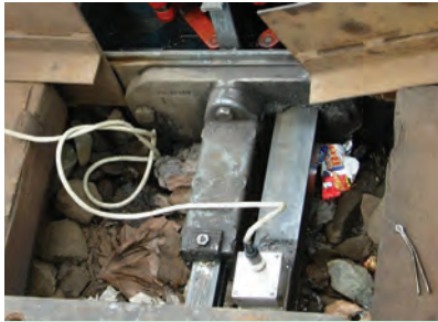
46. ábra. A hajtómű kapcsolórúdján fellelhető súrlódás jelei
