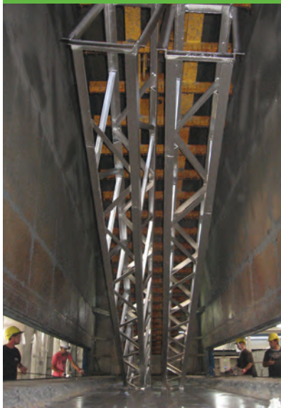
1. ábra. Felsővezeték-tartó oszlopok tűzihorganyzása a NAGÉV Cink Kft.-nél – kiemelés
