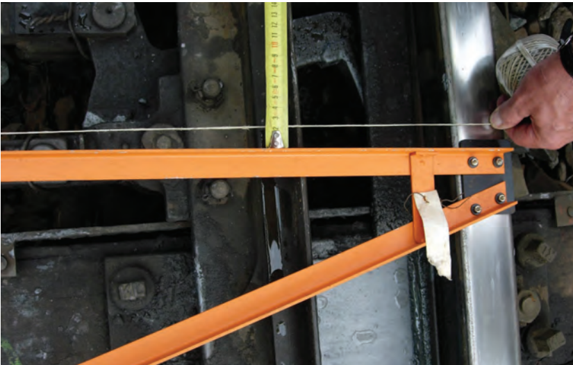
40. ábra. A két félváltó egymáshoz viszonyított helyzetének ellenőrzése
