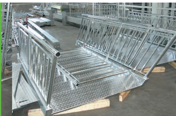
4. ábra. Lépcsőszerkezet fényes-ezüst- tös horgany- bevonattal
