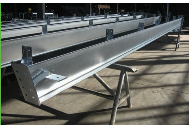
3. ábra. Technigalva- módszerrel horganyzott acélszerkezet (NAGÉV CINK)
