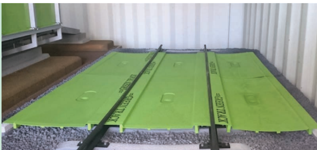
2. ábra. Az új Green Track rendszert szemléltető makett
