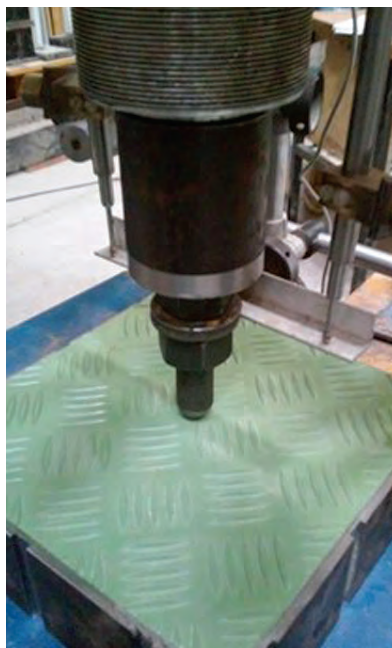
2. ábra. Átszűrődésvizsgálat elvi elrendezése
