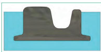
2. ábra. Kiöntött síncsatornás felépítmény TS52 r. sínnel
