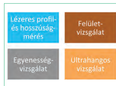
6. ábra. Kész sínek vizsgálati módszerei
