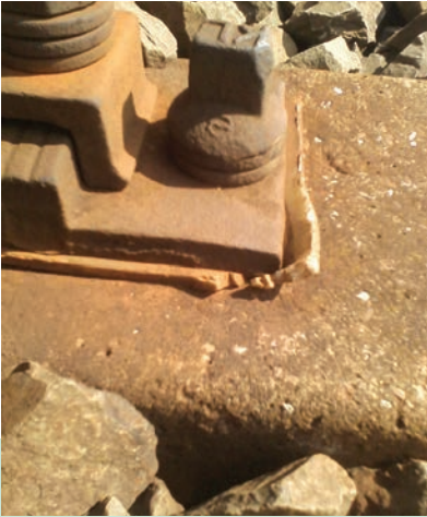
17. ábra. Kinyomódott műanyag alátétlemez
