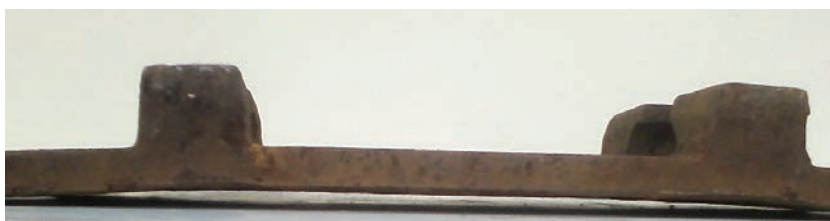
15. ábra. KL csavarok között ívesen meggörbült GEO alátétlemez
