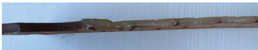
18. ábra. Egyenlőtlenül összenyomódott műanyag alátétlemez
