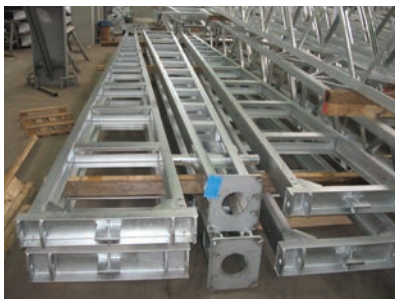
3. ábra. Szimmetrikus keresztmetzetű horganyzott tartók
