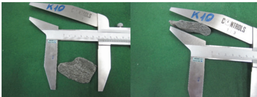
3. ábra. Szemalak mérése szemalak-tolómérővel
