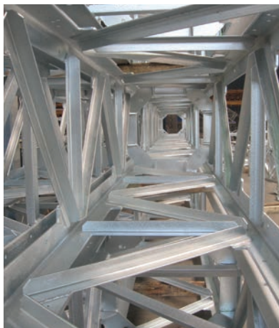
6. ábra. Rácsos tartószerkezet helyes rácsrúd/öv kapcsolata
