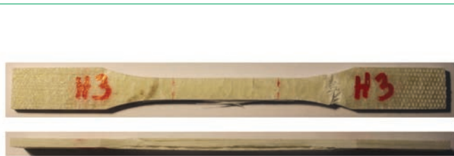
9. ábra. A hosszirányban kimunkált SZPPSZ-240 típusú próbatetek tönkremeneteli húzáskor
