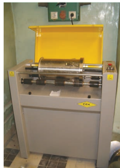
7. ábra. A vasúti mikro-Deval vizsgálat vizsgálóberendezése
