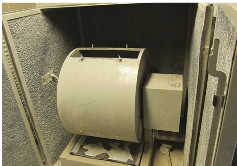
5. ábra. Los Angeles berendezés a BME Anyagvizsgáló laboratóriumában
