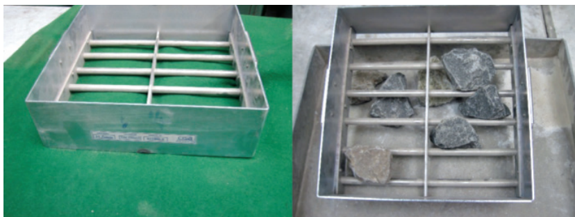
2. ábra. Lemezesség mérése résrostával
