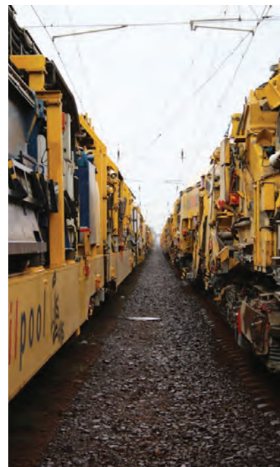
3. kép. A két alépítmény-javító géplánc, a PM1000 és PM200
