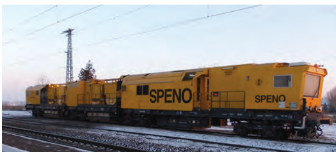
4. kép. Síncsiszolás SPENO sínköszörülő géplánccal
