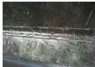
7. ábra. Egységes megjelenés, szép hegesztés
