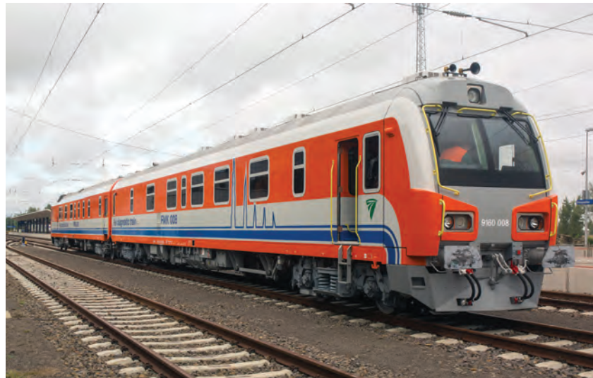
3. ábra. FMK-008 síndiagnosztikai mérővonat
