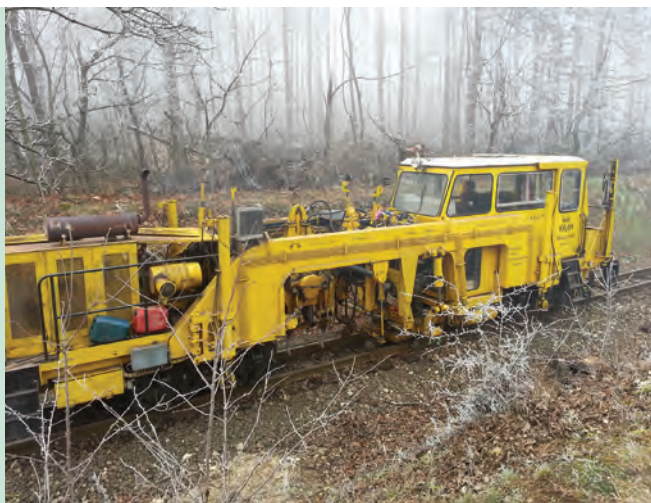
7. ábra. A MÁV-FKG Kft. 760 mm-es vágányszabályozó gépe (Fotó: Török Gergely)
