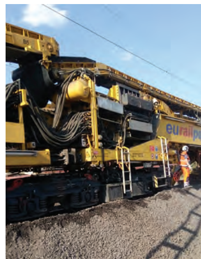
2. ábra. Alépítmény-javító szerelvény PM 1000 URM (Fotó: Szigethy Tamás)
