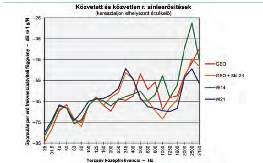
3. ábra. Közvetett és közvetlen rendszerű sínleerősítések eredménye
