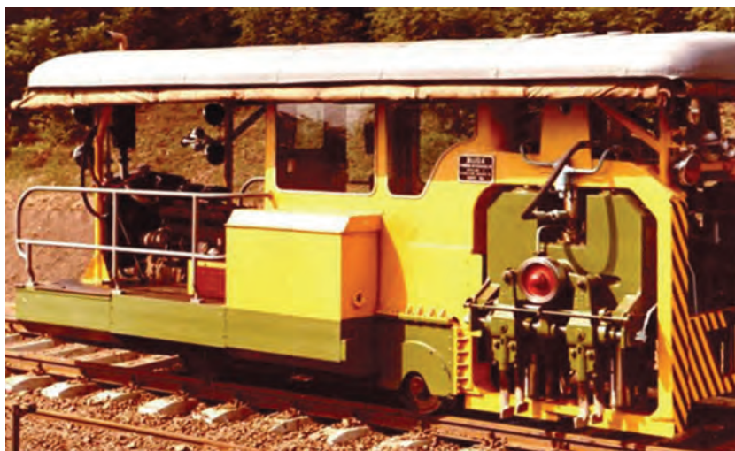
1. ábra. Magyar gyártású „Buda” aláverőgép
