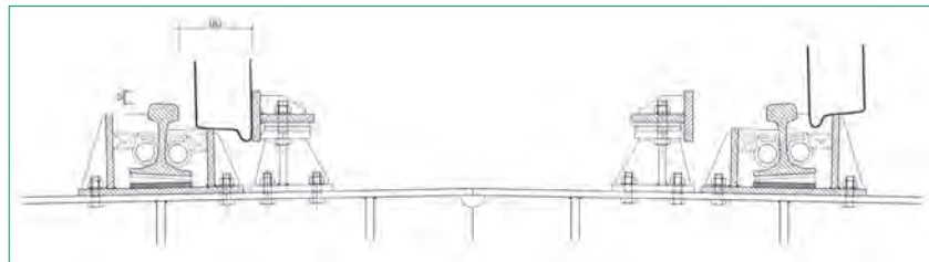
6. ábra. A siklott kerék vezetése (Forrás: MSc Kft.)
