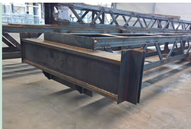
8. kép. A zárt, üreges szerkezet sarokpont- jait meg kell nyitni
