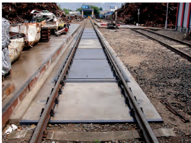
13. ábra. Sekélyaknás, statikus elektronikus vasúti jármű- mérleg (Fotó: Erdődi László Zoltán)
