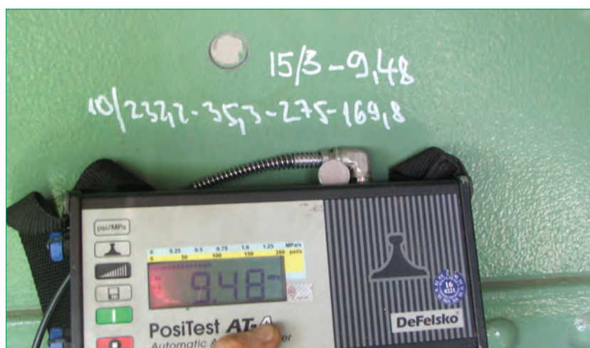
10. kép. Tapadásvizsgálati érték egy mintafelületen a vadnai hídon, 2018
