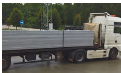
11. kép. Rakomány rögzítése láncsal – helytelen megoldás
