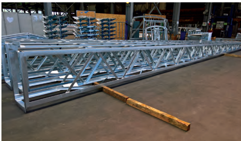
3. kép. L acélból gyártott oszlop
