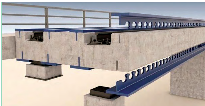
7. ábra. VFT-Rail hídkeresztmetszet alkalmazása PreCo-Beam technológiával [4]
