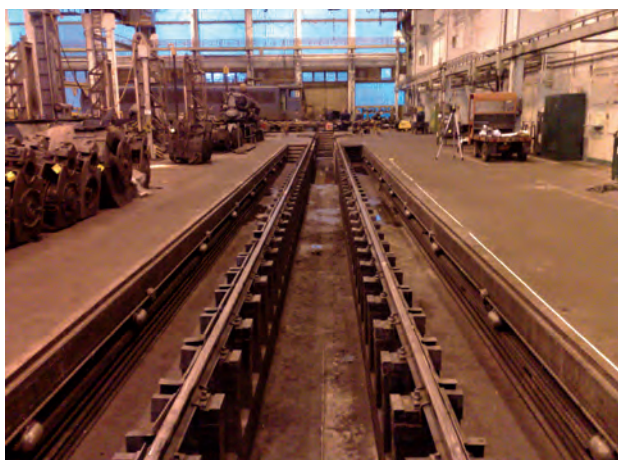
6. ábra. Háromaknás vizsgálócsatorna (Fotó: Erdődi László Zoltán)
