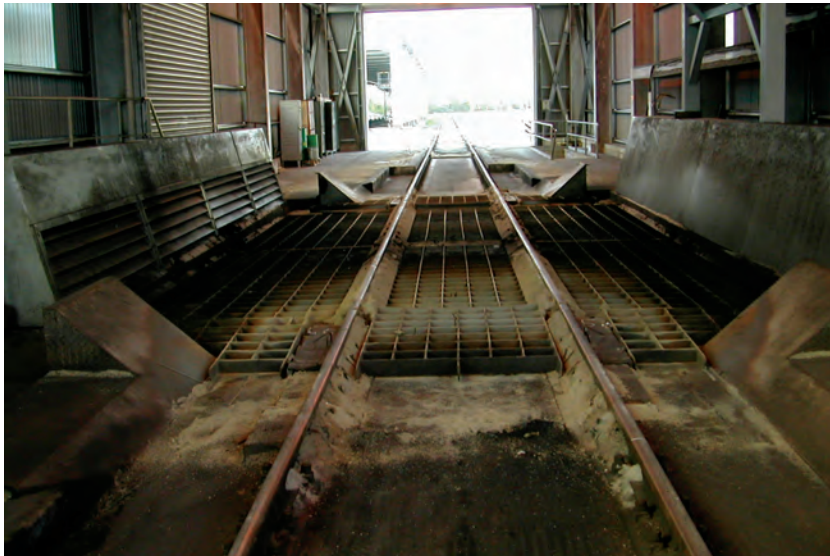
2. ábra. Vagonbuktató üzemen kívüli állapotban (Fotó: Erdődi László Zoltán)
