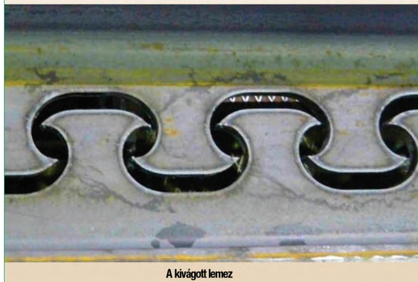
8. ábra. A PreCo-Beam kapcsolat vágása [5], [6]
