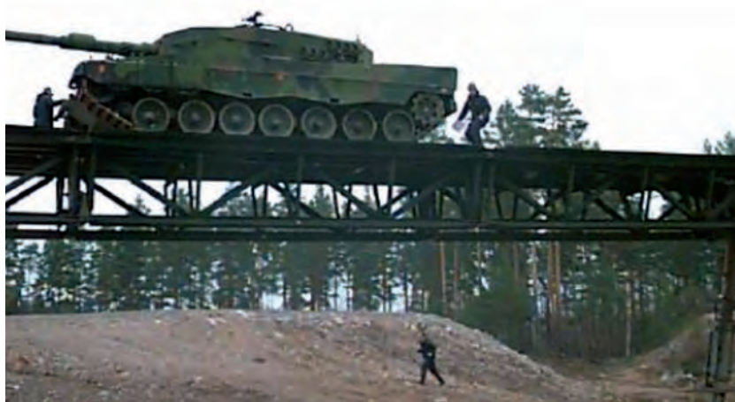
9. ábra. Fast Bridge 48 összeszerelt és üzem közbeni állapotban [10]
