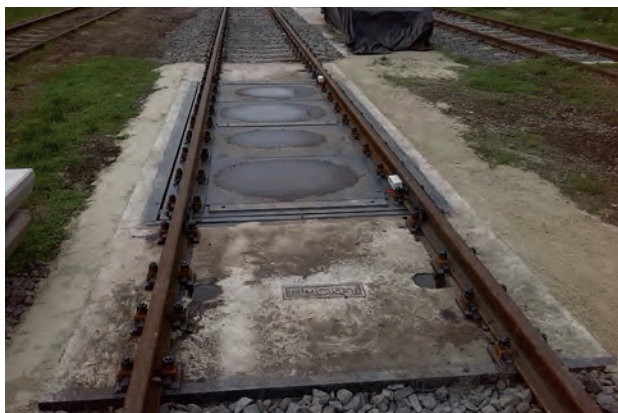
14. ábra. Sekélyaknás, dinamikus elektronikus vasúti járműmérleg (Fotó: Erdődi László Zoltán)
