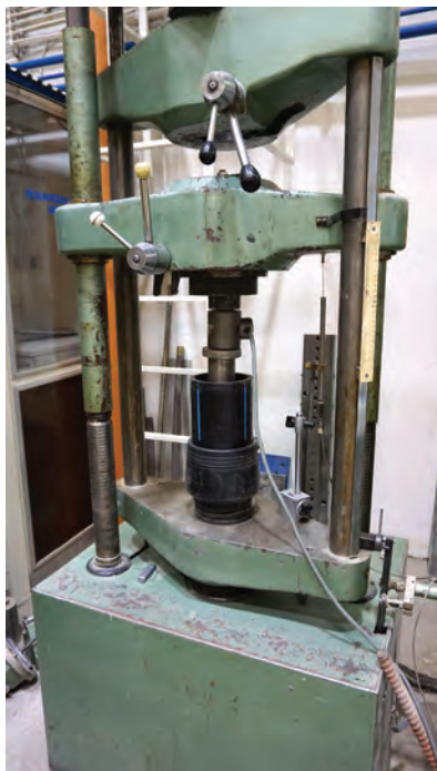
10. ábra. A vizsgálati minta a ZD-40 törőgépben
