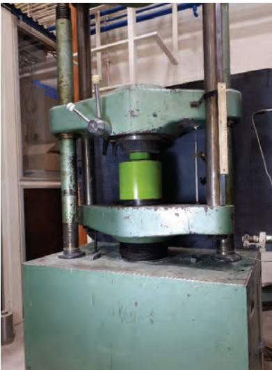
7. ábra. Roncsolás ZD-40 törőgéppel
