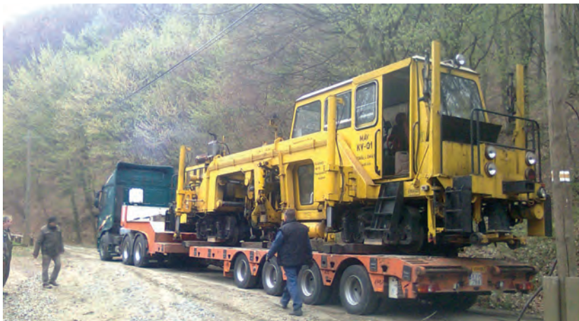
6. kép. KV-01 keskeny nyomtávolságú szabályozógép szállítása
