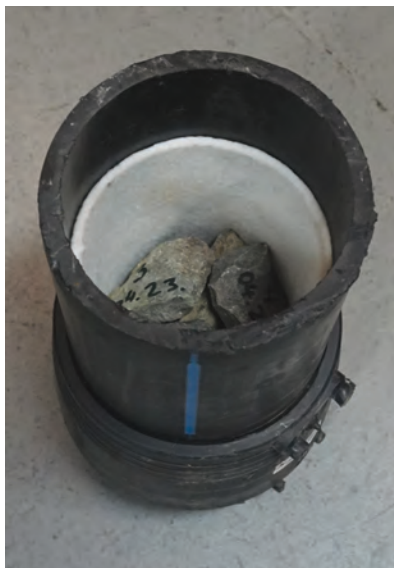
9. ábra. A geotextíliával kibélelt KPE-cső a szemcsehalmazzal
