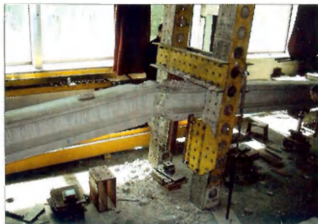
6. kép. Kísérleti vizsgálatok HSC/HPC betonból készült gerendákkal
