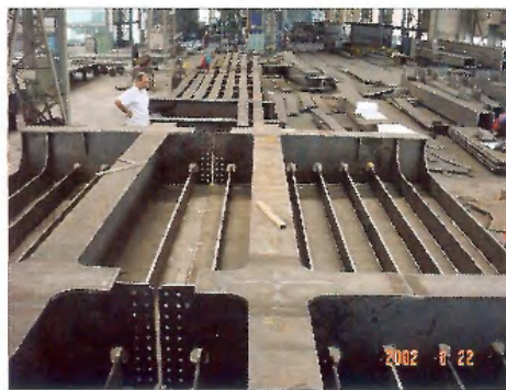
10. ábra. Pályaszerkezet gyártása, kereszttartó illesztés
