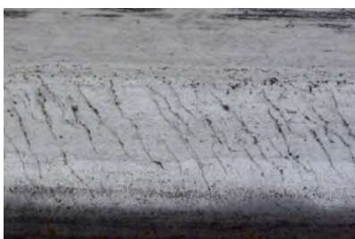
7. ábra. A fejrepedezettség – head check hiba [5]
