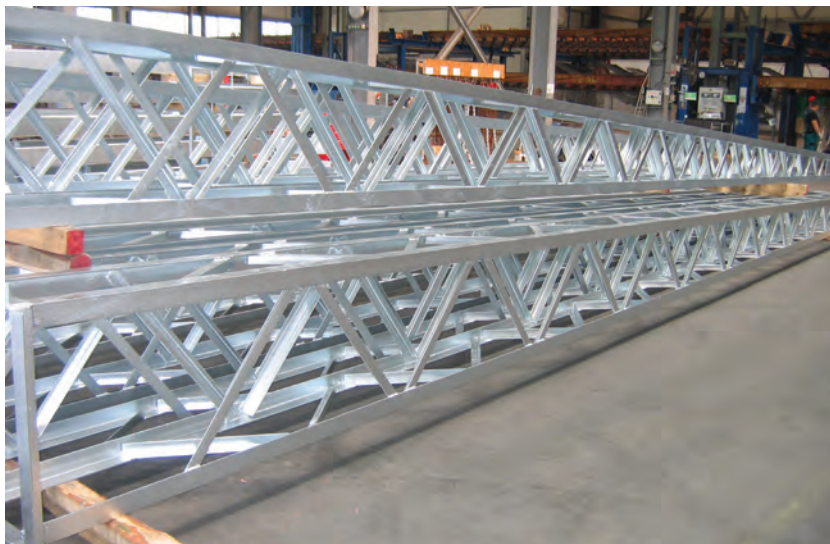
2. ábra. Nagyméretű horganyzott acélszerkezet. (Fotó: Nagév-archívum)
