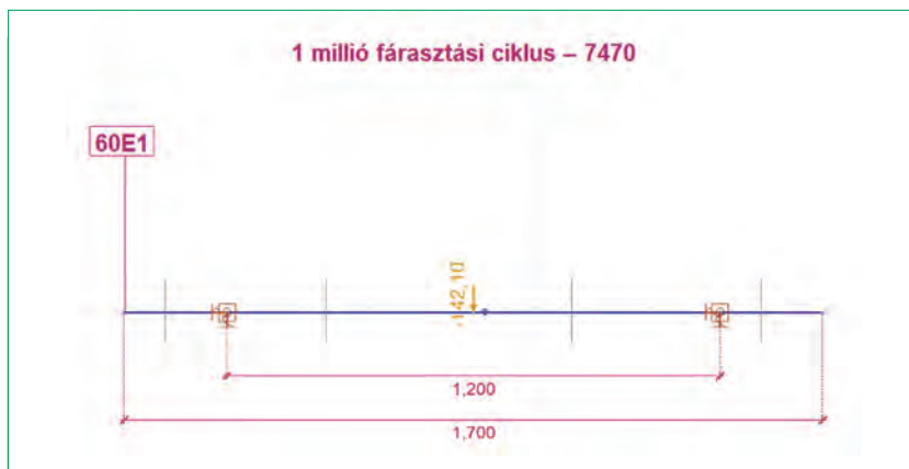
1. ábra. Sematikus, „előkalibrált” FEM-modell a ragasztott-szigetelt sínillesztések kalkulációjára 60-as sínrendszer esetén
