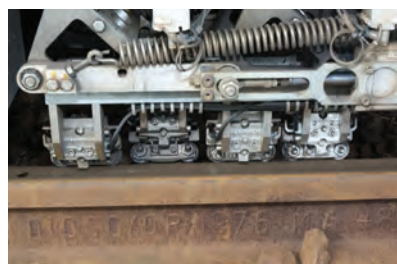
15. ábra. A mérővonatra szerelt örvényáramos mérőműszer [5]
