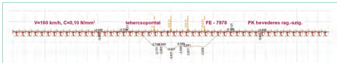
8. ábra. A PK hevederes ragasztott-szigetelt sínillesztés – keresztaljas alátámasztásokat is figyelembe vevő – vágánymodell, V=160 km/h, C=0,10 N/mm 3 , LM71-es tehercsoport (dinamikus kerékterheléssel) és a fásztás előtti állapot figyelembevételével ( \alpha_{srh}=7978 kNm/rad)
