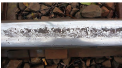
9. ábra. A repedésfészek – belgrospi hiba [5]
