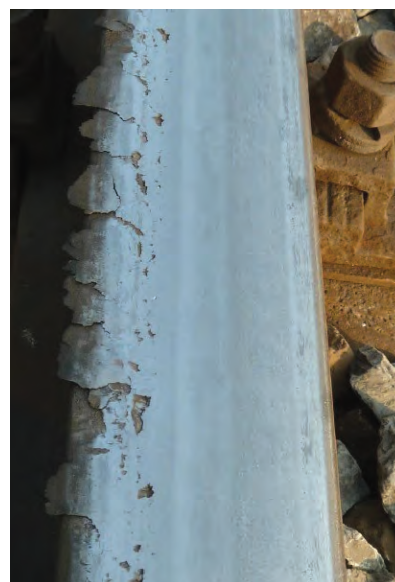
10. ábra. A nyelvszegélyképződés – tongue lipping hiba [5]
