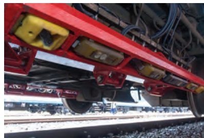
14. ábra. A mérőgerendába beépített ultrahangos mérőfejek [5]
