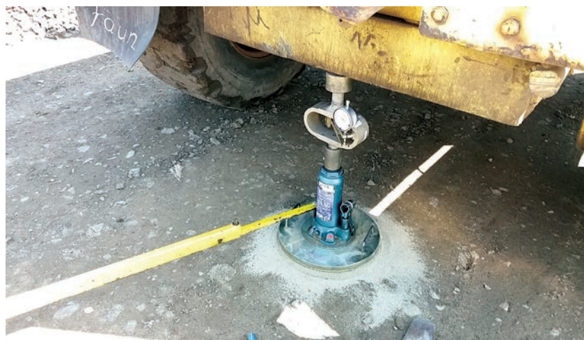
5. ábra. Az alépítmény teherbírásának ellenőrzése (Fotó: Szabó István)
