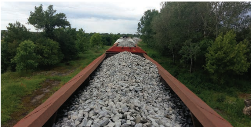
10. ábra. Próbaterhelő járműszerelvény (Fotó: Legeza István)
