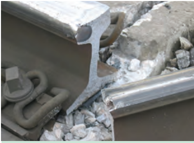
5. ábra. Head Check hibából eredő sintörés
