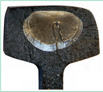
1. ábra. Ultrahangos vizsgálattal kimutatott sínhiba
