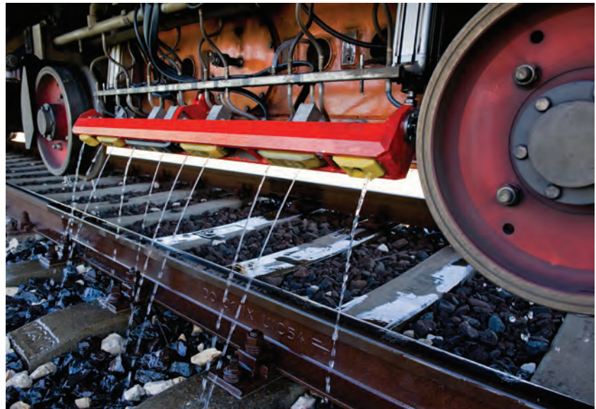
2. ábra. Mérő forgóváz és mérőgerenda az ultrahangos vizsgálófejekkel
