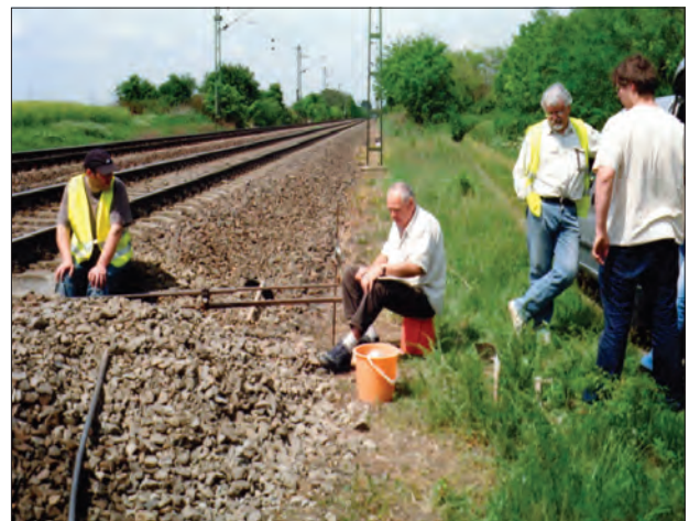
18. ábra. Lébény-Kimle jobb vágány, statikus tárcsás teherbírás-vizsgálat előkészítése (1622+63,10 – 1622+69,40 szelv.)
