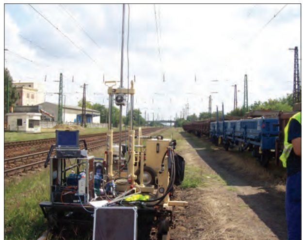
32. ábra. CPT szondázás Törökszentmiklóson
