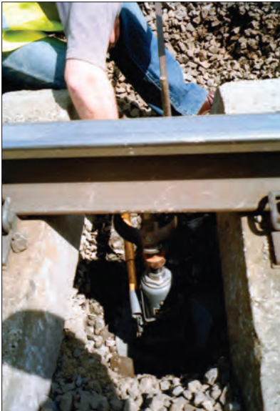
19. ábra. Lébény-Kimle jobb vágány, statikus tárcsás teherbírás-vizsgálat
