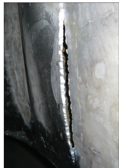
8. ábra. Horganyzás utáni deformáció az átlapolásnál
