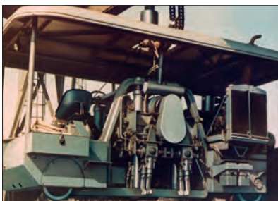
2. ábra. Az első, teljesen hidraulikusan működtetett vágányszabályozó gép
