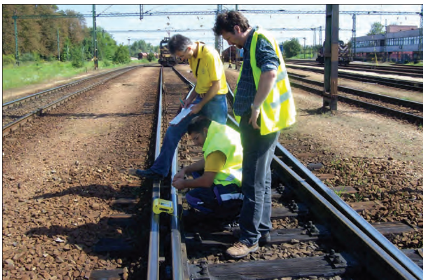
29. ábra. Keménységmérés Murakeresztúr állomáson 2010. szeptember 14-én
