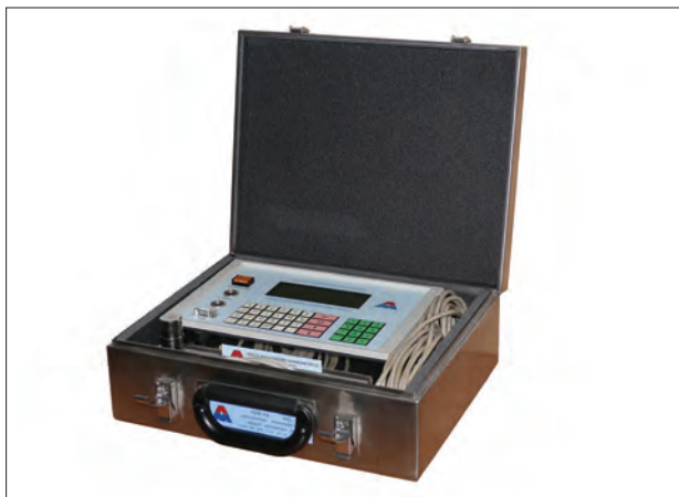
3. ábra. VEM-02 típusú erőmérő
