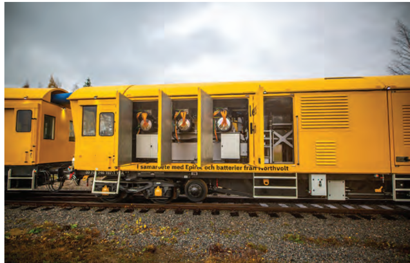
A munkagépekkel felszerelt kibocsátásmentes vasúti karbantartó jármű
