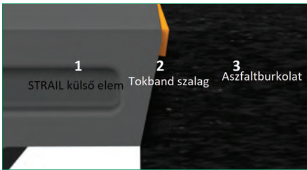
2. ábra. STRAIL külső elem aszfaltcsatlakozással
