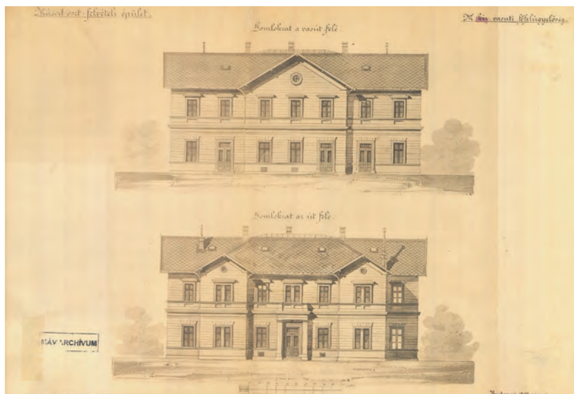
6. ábra. II. osztályú felvételi épület típustervhomlokzatok (MÁV, 1883)
