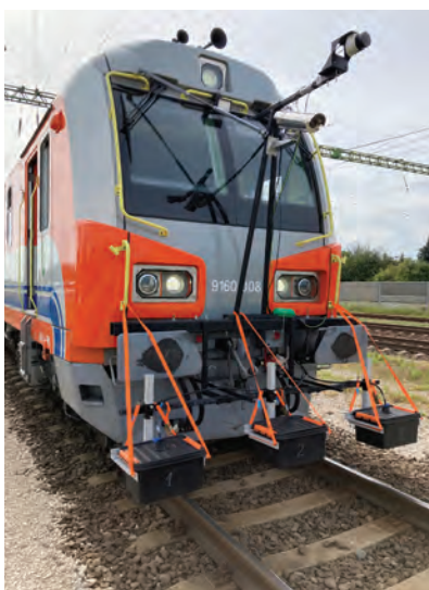
1. ábra. Georadar mérőrendszer az FMK-008-as mérőkocsin. (Fotó: Takács Balázs)
