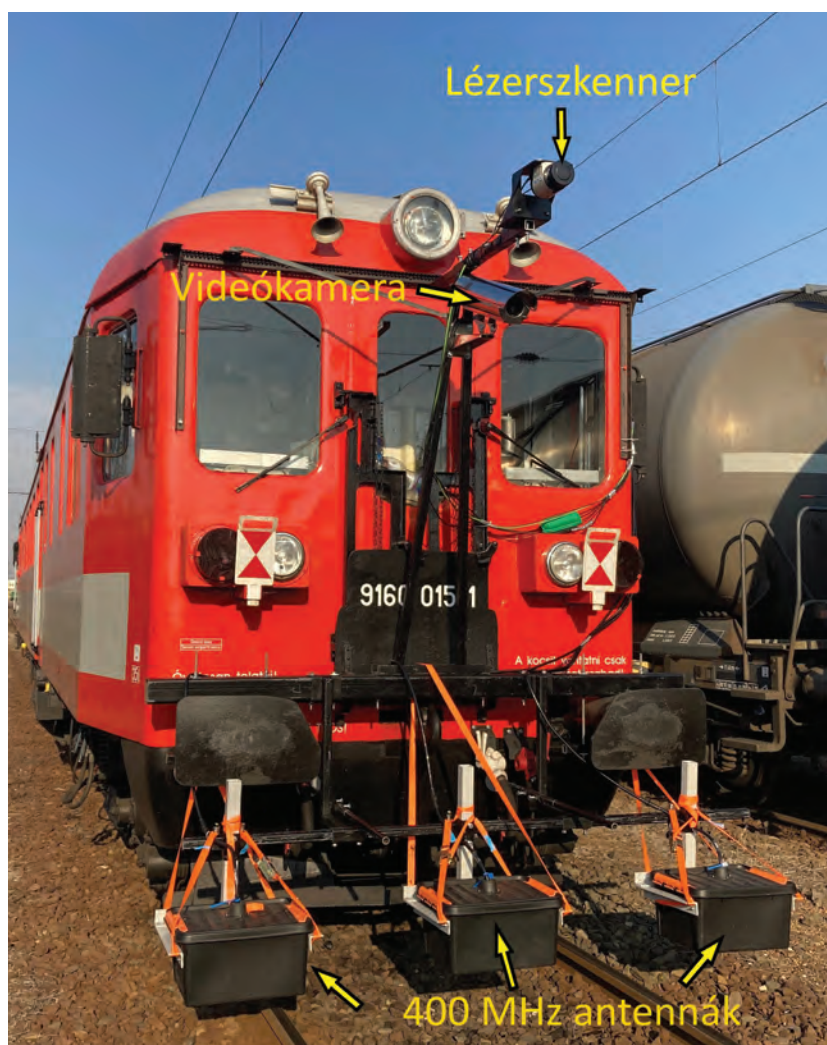
6. ábra. A GPR mérőrendszer és annak részei az AB-15 motorkocsin. (Fotó: Takács Balázs)
