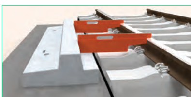
12. ábra. B-széles szegélygerenda beépítése beépítősablon segítségével
