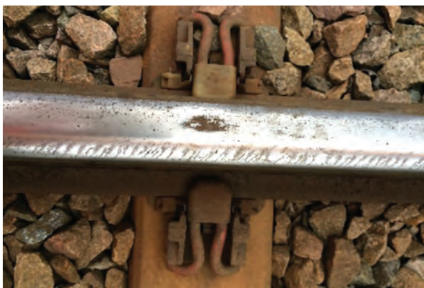
6. ábra. Sínfej-hajszálrepedésekkel (HC) és squat hibával terhelt sín
