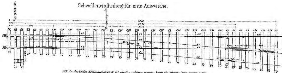
5. ábra 32,5 kg-os sínekből készült kitérő
