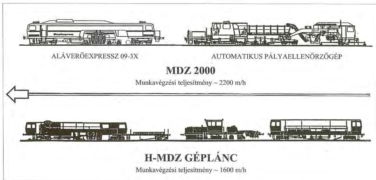
8. ábra. H-MDZ és a 09-3X aláverőexpressz az automatikus pályaellenőrző géppel
