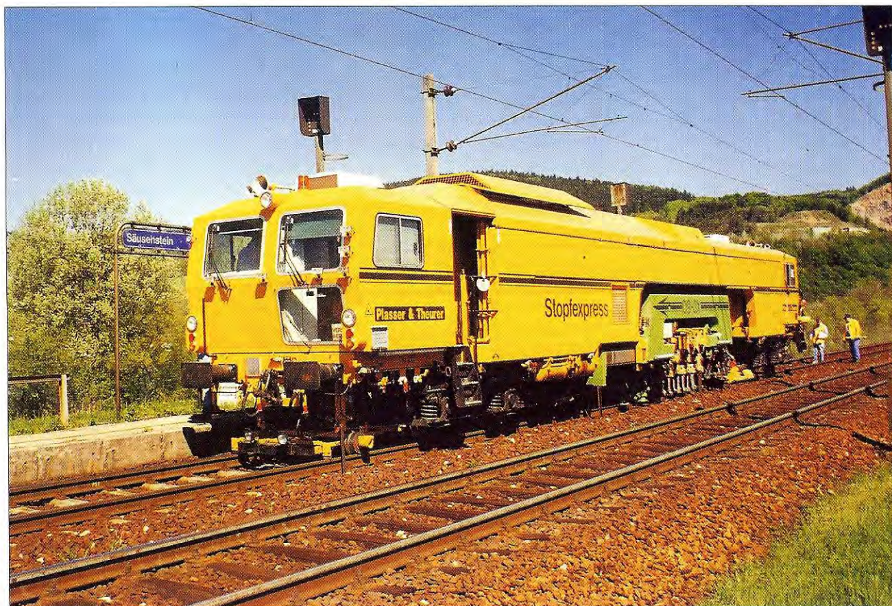
6. ábra. Folyamatosan működő, 3 alj aláverésére alkalmas 09-3X aláverőexpressz
