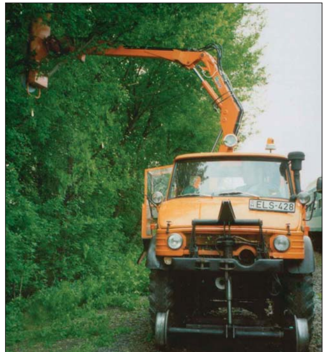
8.kép – Unimogra szerelt Hidrot-adapter
