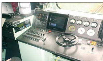
7. ábra – ETCS Mozdonyfedélzeti egység (V63-sorozat)
