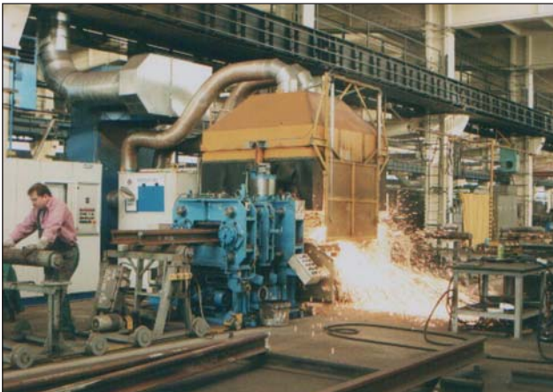
1. kép – A leolvastó tompahegesztő gép és a varratlevezető berendezés
