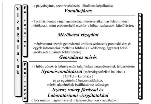
2. ábra – Üzem alatti pálya diagnosztikai módszerei [4]
