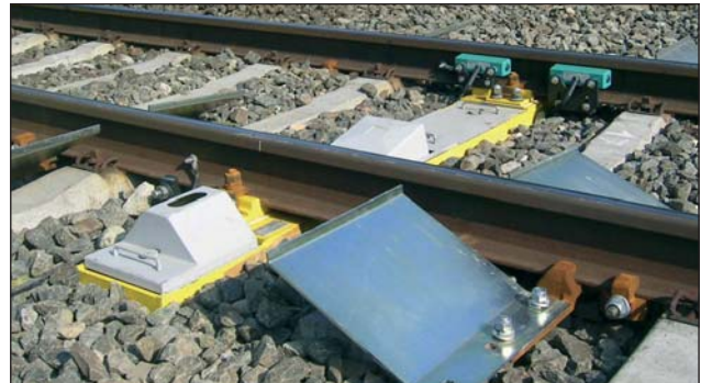
9. kép – A hőnfutásjelző mérőegység
