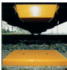
6. ábra – ETCS Fedélzeti és pálya men- ti alrendszer kapcsolata
