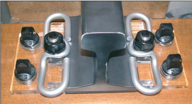
3. ábra – VOSSLOH-gyártmányú, "KS"-jelzésű sínleerősítés, Skl-24 típusú szorítórugóval (a korábbi Skl-12 típusú szorítórugó nagyobb rugalmasságú változata)
