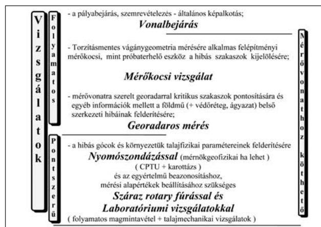
2. ábra – Üzem alatti pálya diagnosztikai módszerei [4]
