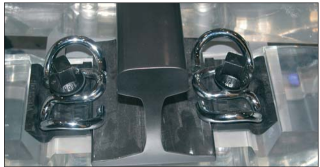
6. ábra – VOSSLOH-gyártmányú, "W-14"-jelzésű sínleerősítés, Skl-14 típusú szorítórugóval (+3/–10 mm nagyságú függőleges irányú szabályozási lehetőség)
