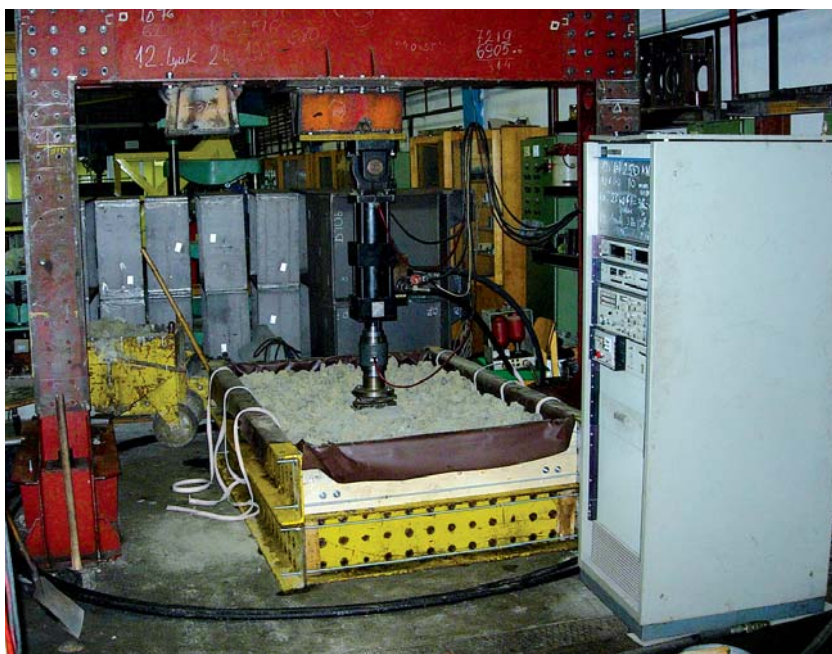
16. kép – A statikus nyomóvizsgálat végrehajtása ragasztás nélküli állapotban
