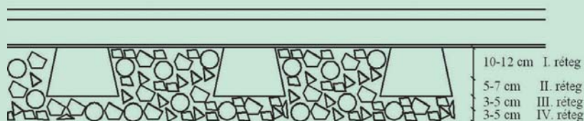
21-29 cm Ágyazott réteg 19. ábra A vágat rétegrendje
