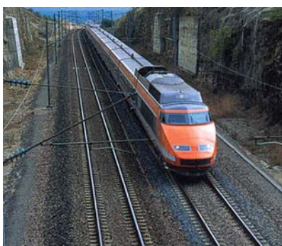
7. kép – Kőfelverődés megakadályozása érdekében ragasztott ágyazatú vasúti pálya
