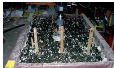
19. kép – A statikus nyomóvizsgálat végrehajtása teljes ragasztás utáni állapotban
