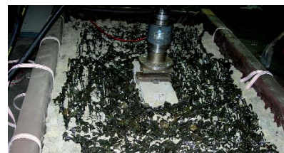
17. kép – A statikus nyomóvizsgálat végrehajtása felső ragasztás utáni állapotban
