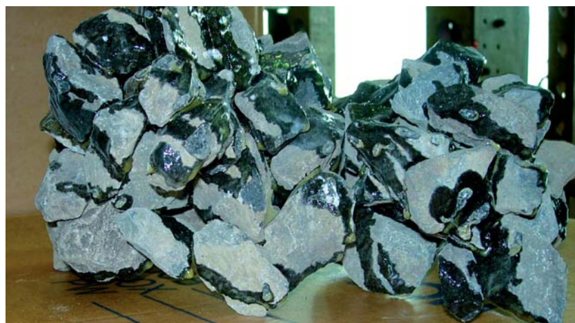
1. kép – Élüknél és kapcsolódási pontjaiknál összeragasztott zúzottkövek
