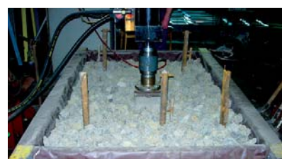
18. kép – A statikus nyomóvizsgálat végrehajtása alsó ragasztás utáni állapotban
