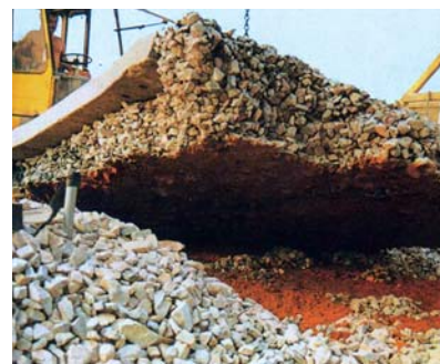
2. kép – A zúzottkövek összeragasztásával előállított térbeli test
