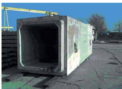
5. kép – Összeszerelt 1,5x1,5x2 m-es elemek az összehúzásra és emelésre szolgáló kapcsolóelemekkel, víztartási próba előtt
