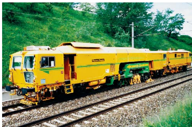
2. ábra Dynamic Stopfexpress 09-3X – folyamatosan üzemelő, három aljat egyszerre aláverő gép, dinamikus vágány- stabilizátorral
