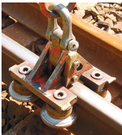
3. kép – A sínigomboló fej „kigombolást” végez
