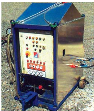
5. kép – A ragasztóanyag felhordása kisgéppel
