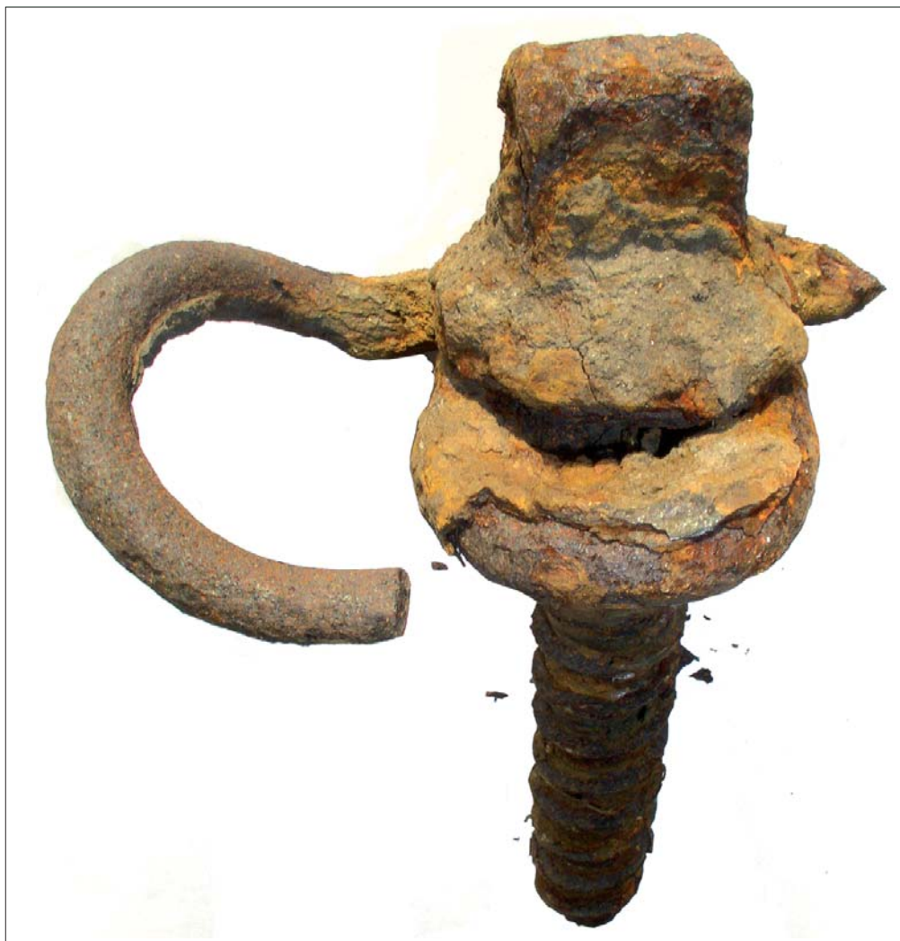
4. kép. Korrodált síncsavar és kegyel
