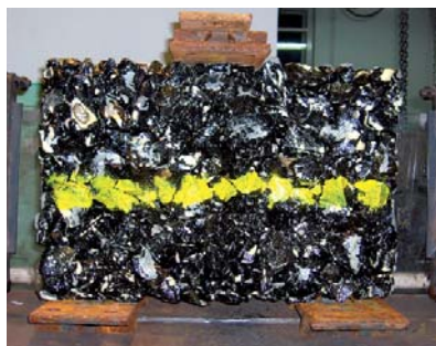
28. kép. A 60x40x15 cm méretű ragasztott ágyazati próbatest
