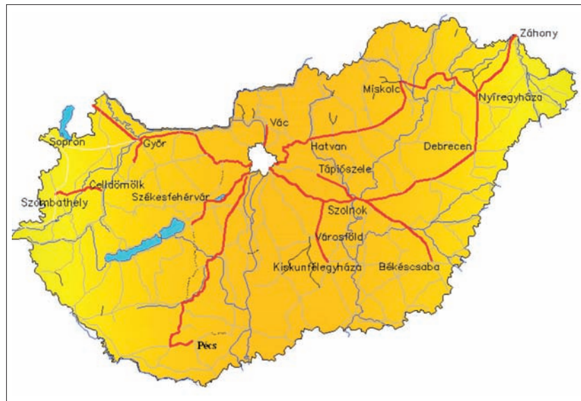
4. ábra Hatóságilag engedélyezett legnagyobb sebességek v \geq 120 km/h
