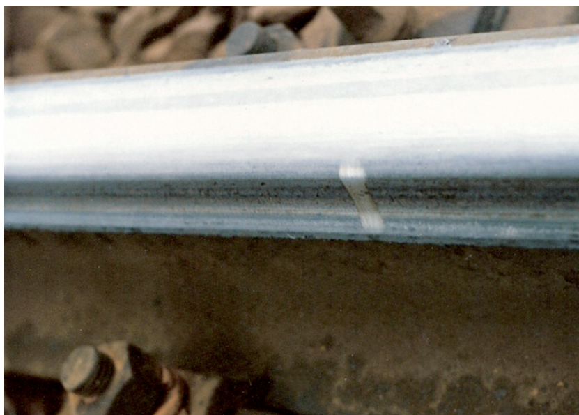
5. ábra. Az SK-680 típusjelű kenőanyag kialakult kenő(film)rétege a sín vezetési felületén, keresztirányú töréssel szemléltetve
