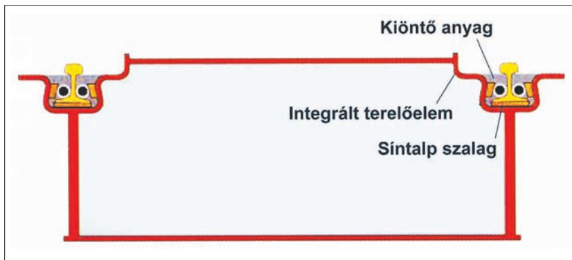
6. ábra. Silent Bridge hídszerkezet
