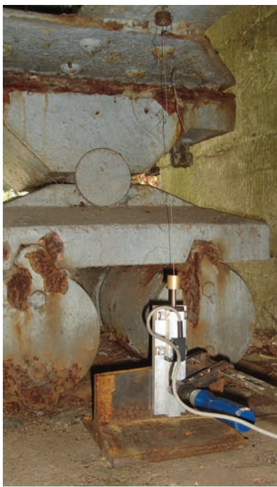
4. kép. Sarubenyomódás mérése
