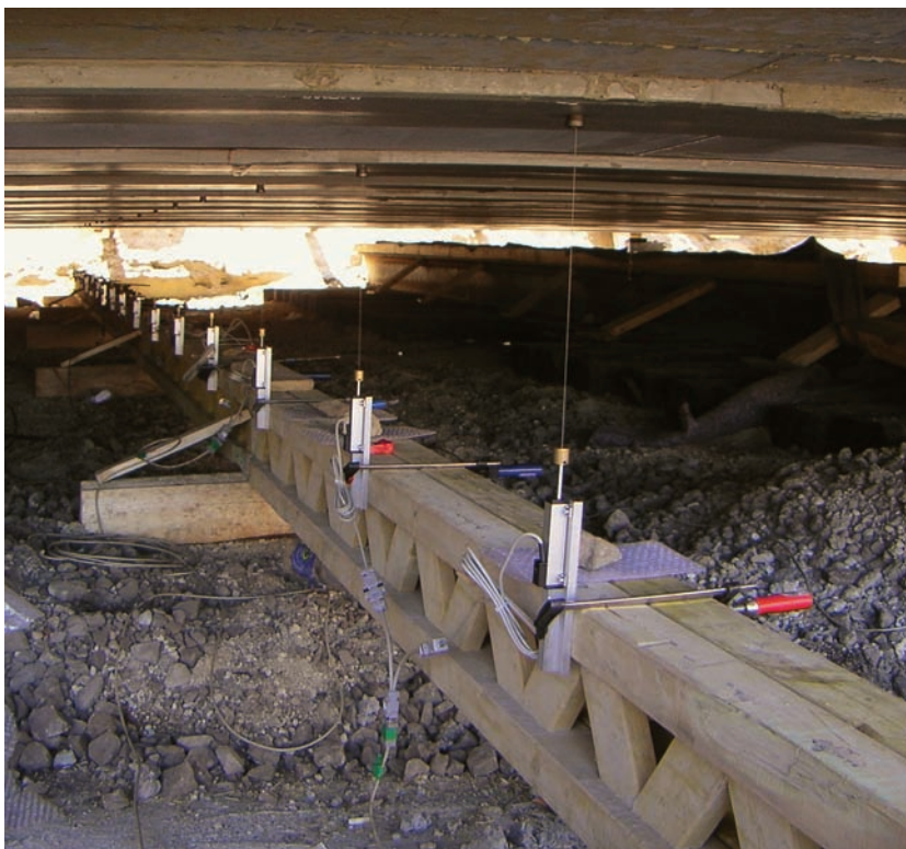
5. kép. Miskolc, Bosch-híd, kereszteloszlás meghatározása próbaterhelés során
