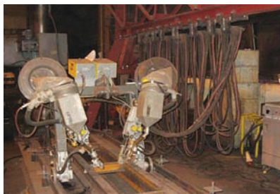
1. kép. Kétféjes fedőporos trapéz-borda hegesztőgép
