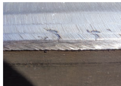
14. ábra. Mosonmagyaróvári 14-es kitérő HC hibái síncsiszolás közben
