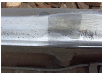
4. ábra. HC sínhibák a hegesztés mindkét oldalán (a hegesztéshibamentes)
