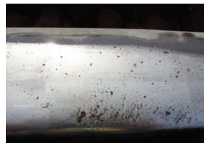
5. ábra. HC hiba csak a hegesztésben
