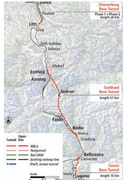
16. ábra. A Gotthard vasút helyszínrajzi vonalvezetésének módosulása a három új bázisalagút (Zimmerberg-, Gotthard-, Ceneri-) megépítésével
