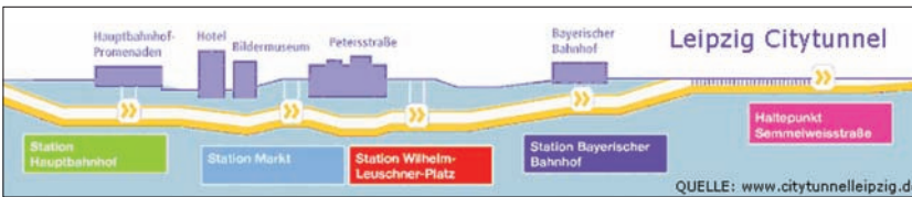
14. ábra. A „Citytunnel” magassági vonalvezetése Lipcse belvárosa alatt
