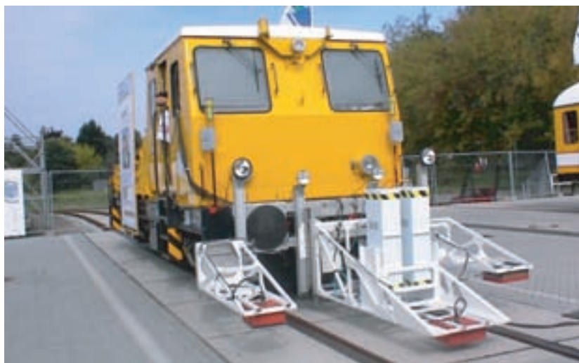
6. ábra. Munkagépre szerelt mérőrendszer
