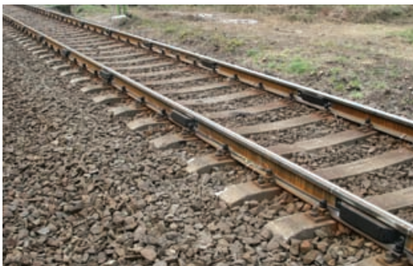
1. ábra. eRDM mérőrendszer a Mezőkeresztes–Mezőnyárad–Mezőkövesd szakaszon
