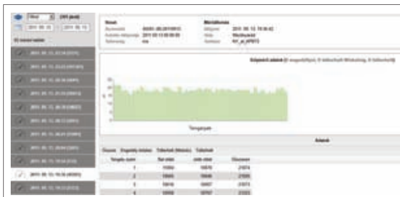
3. ábra. eRDM felhasználói felület. Bal oldalon láthatóak a mért szerelvények, középen fenn a tengelyterhelések szimbolikus megjelenítése, középen lenn a mérési adatok a bal kerék, jobb kerék és a tengely terhelésére vonatkozóan
