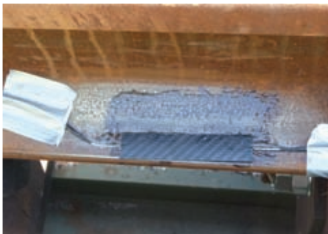
9. ábra. Mérőszensor elhelyezése sínen
