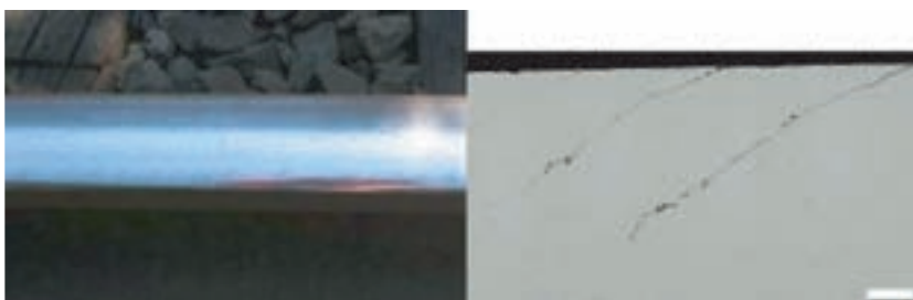
3. ábra. Sínef-hajszálrepedés általános és mikroszkopikus képe
