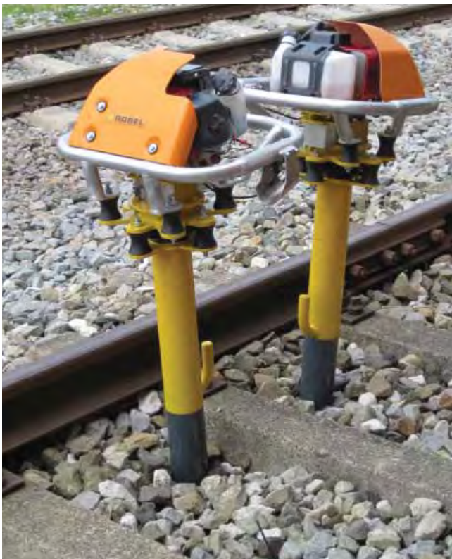
1. ábra. Benzinmotorral szerelt függőleges kézi aláverő párba állítva
