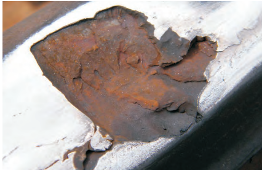
5. ábra. A forgalmat veszélyeztető sínhiba
