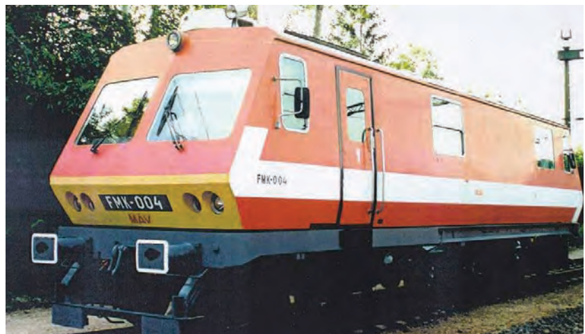
2. ábra. FMK-004 vágánygeometriai mérőkocsi
