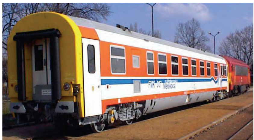
3. ábra. FMK-007 vágánygeometriai és dinamikai mérőkocsi
