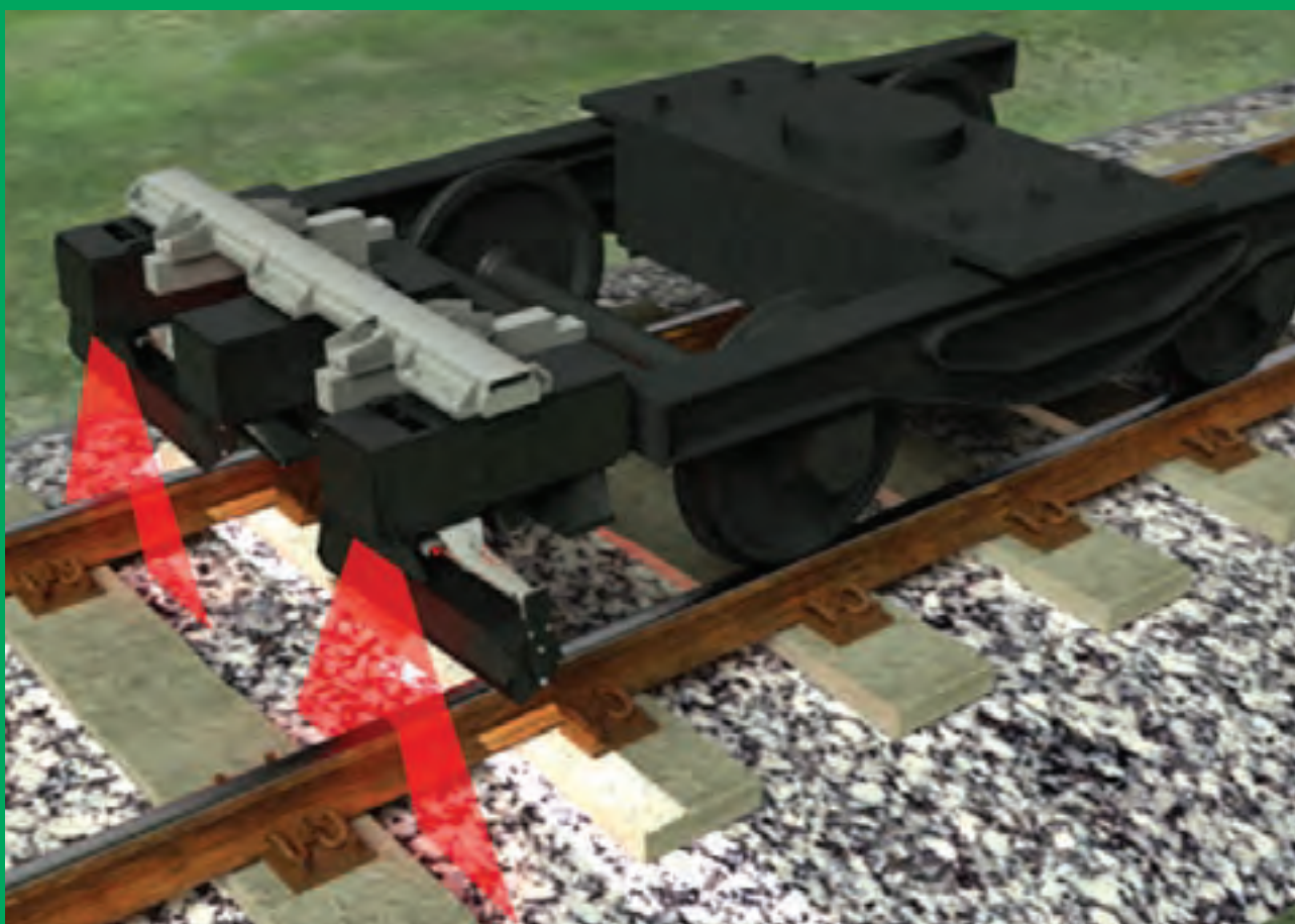
A Videós Pályafelügyeleti Rendszer (VPR) működése
