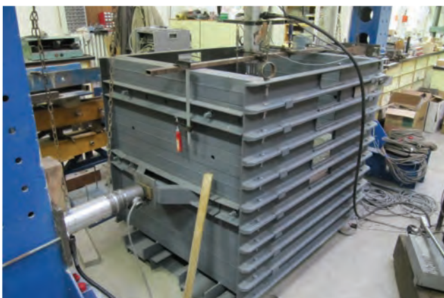
5. ábra. A vizsgálatokhoz előkészített többszintes nyíróláda
