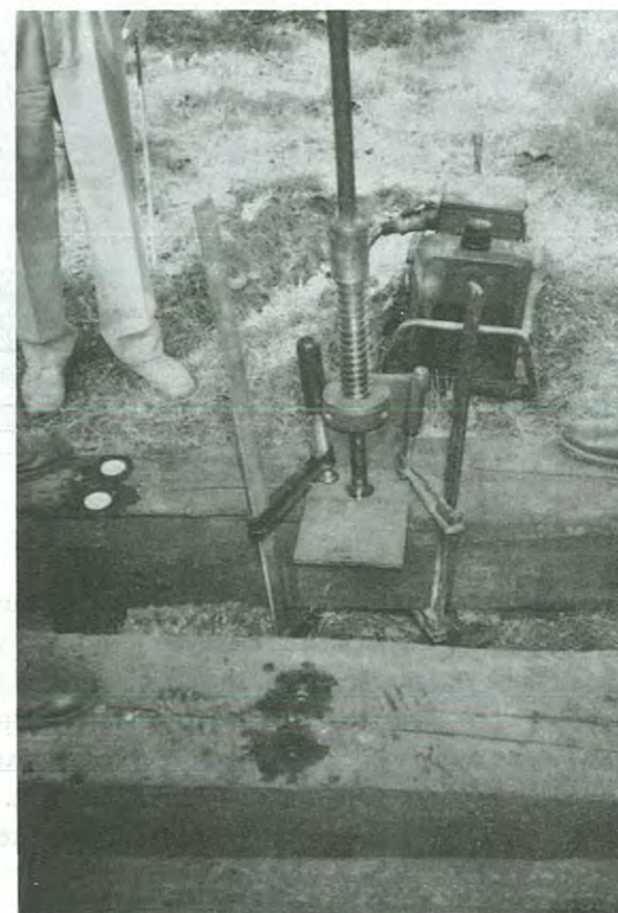
34. ábra Speciális szerszám a menet kialakításához
