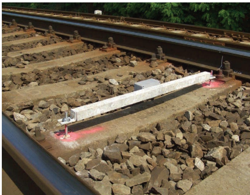
12. ábra. Alumíniumgerendára szerelt dőlésmérő szenzor a jobb vágányban (Fotó: Pokorny Bence)
