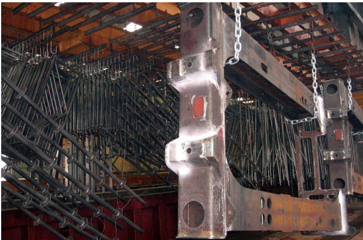
10. ábra. Horganyzáshoz felfüggesztett termékek
