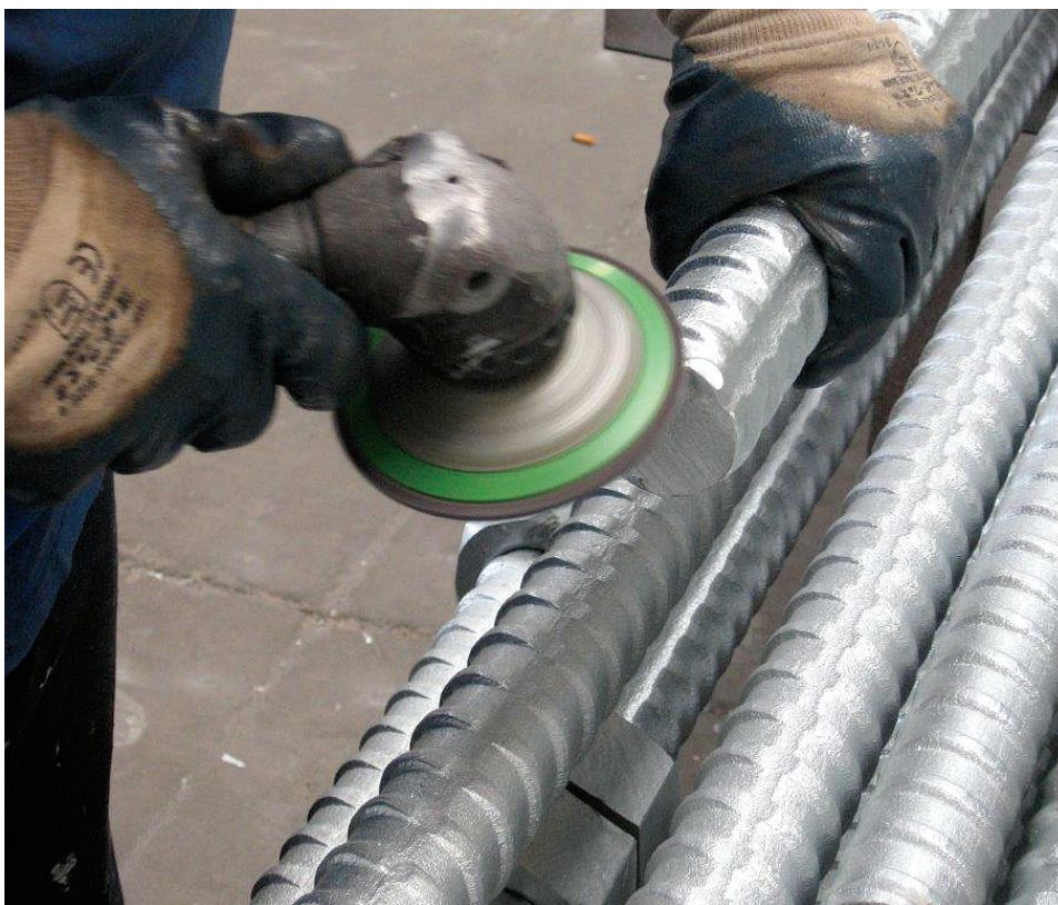
12. ábra. Felvastagodások kézi-gépi eltávolítása
