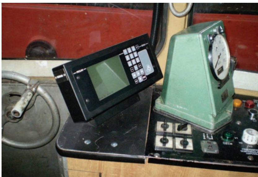
2. ábra. Az MFB kijelzője a Teloc mérőórával egy Bz vezetőállásán 2
