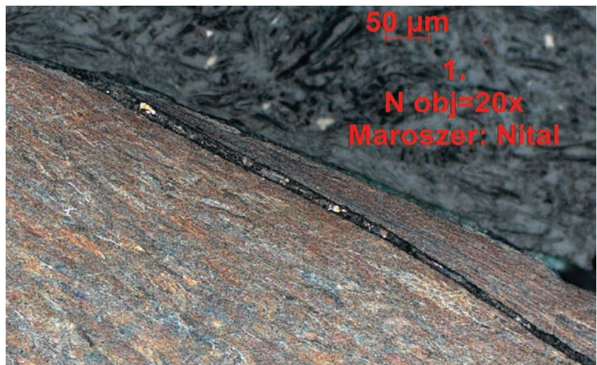
6. ábra. A deformálódott szövetszerkezet és a repedés
