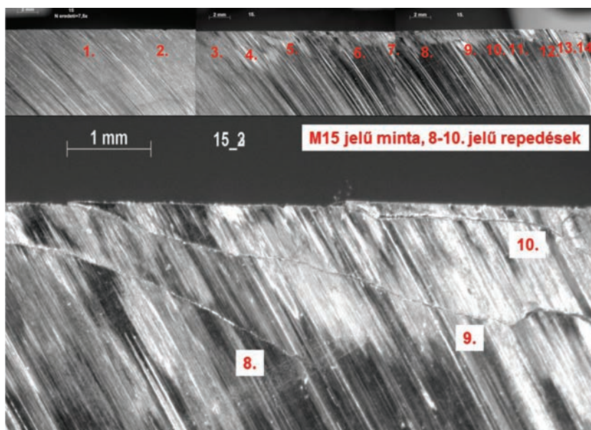
8. ábra. Repedések a sínfej hosszmeteszében (M15 jelű minta)
