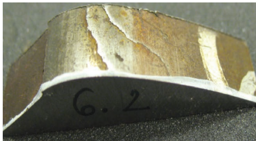
3. ábra. Kimunkált próbadarab csiszolat készítéséhez
