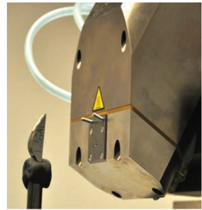
9. ábra. A vizsgált minta és a 225 kV-os mikrofókuszú röntgencső
