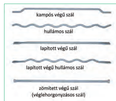
1. ábra. Acélszálak kialakítása [1]
