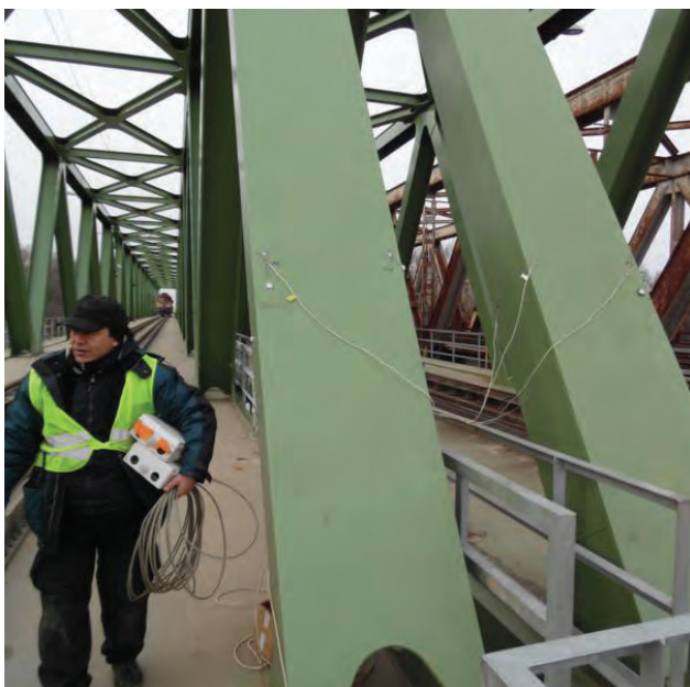
12. ábra. Nyúlásmérő bélyegek felszerelése a feszültségméréshez (Fotó: Szeifert Tamás)
