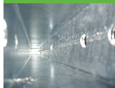
4. ábra. A zárt szelvény belső felületén tökéletes a védőbevonat
