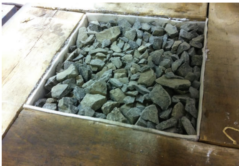
4. ábra. A laboratóriumi pulzátoros fásztóvizsgálathoz használt összeállított elrendezés az egyik vizsgált zúzottkőmintával
