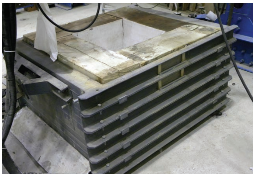
3. ábra. A laboratóriumi pulzátoros fásztóvizsgálathoz használt láda a homokra terített Viacon GEO PP TC 1200 típusú geotextiliával, és a vasúti fa keresztlappal kialakított „doboz”
