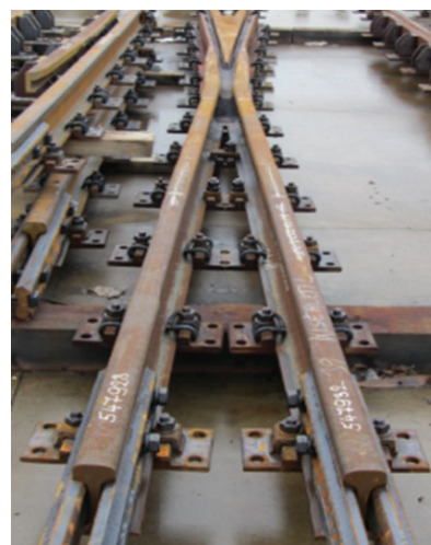
8. ábra. Keresztezési rész 1:40 síndőlés esetén
