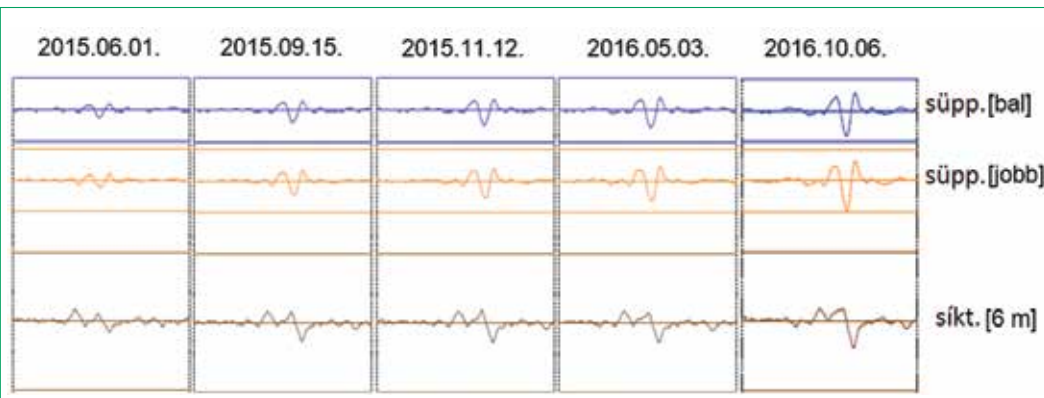
2. ábra. Az 1439+60-as útátjáró (1439–1440 sz. bal vágány) mérővonati eredményeinek alakulása 2015. június és 2016. október között: C2_160
