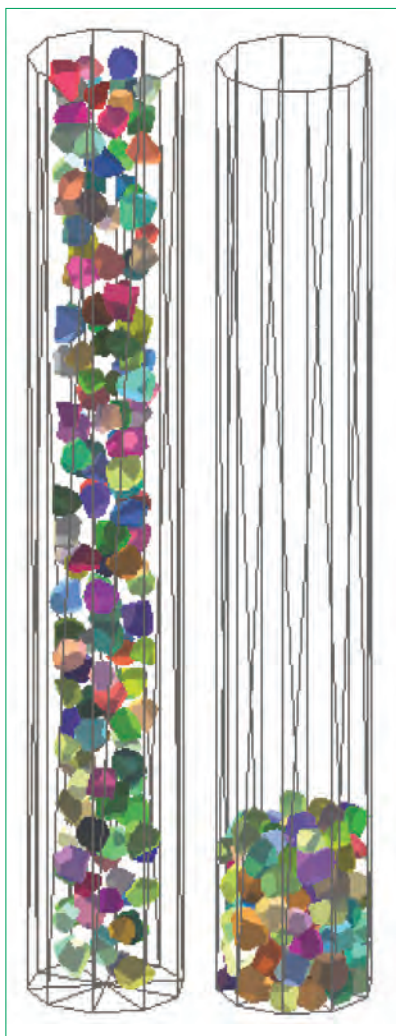
8. ábra. Létrehozott elemek a gravitációs ülepítés előtt és után
