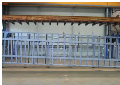
5. ábra. Egy 15 m hosszú és magas alváz acélszerkezete
