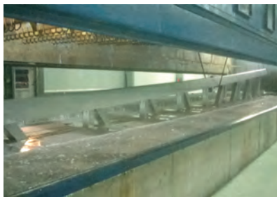
4. ábra. Nagy méretű, rácsos tartó szabad szemmel is jól látható alakváltozása
