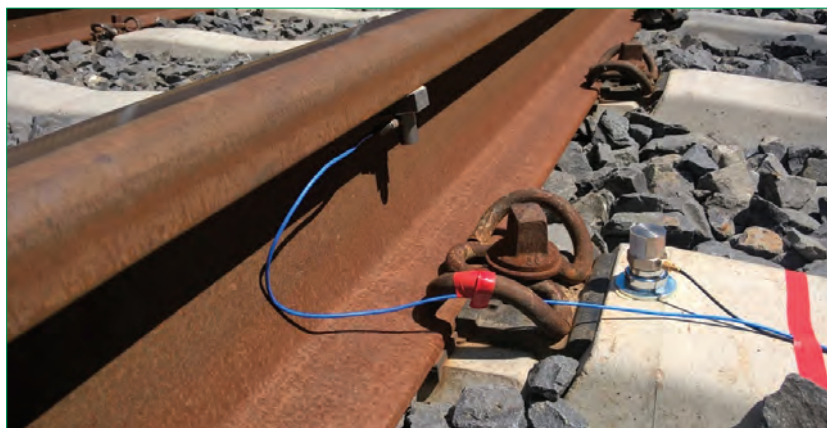
2. ábra. Sínfej alatt és keresztaljon elhelyezett rezgésérzékelők
