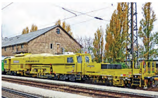
18. ábra. Dinamikus vágánystabilizátor (Unimat)
