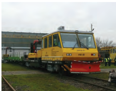
21. ábra. Univerzális forgóvázás darus jármű (UFDJ) hótoló szerelvénnel
