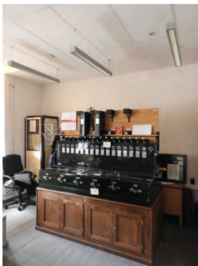
10. kép. Az újragyártott Siemens–Halske rendelőkészülék (Forrás: MÁV Zrt. MTF)
