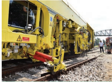
3. kép. Munkában az FKG Kft. új aláverőgépe (Fotó: Szalai Tamás)
