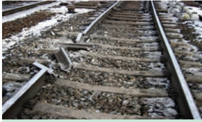
4. ábra. HC-hibából eredő sántörés
