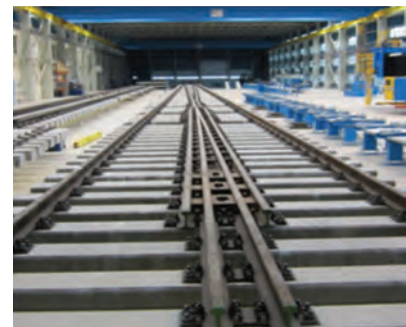
12. ábra. Mozgatható keresztelési csúcs hosszú könyöksínnel, fő- és mellécsúcsos kivitelben [2]
